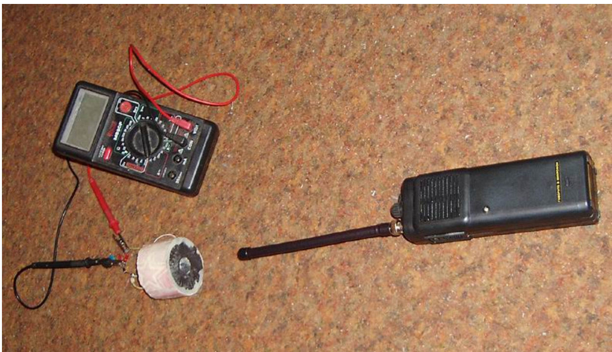
Рис. 9.2 Приборы, использовавшиеся при эксперименте. Слева антенна «таблетка», справа «Беркут-603»
