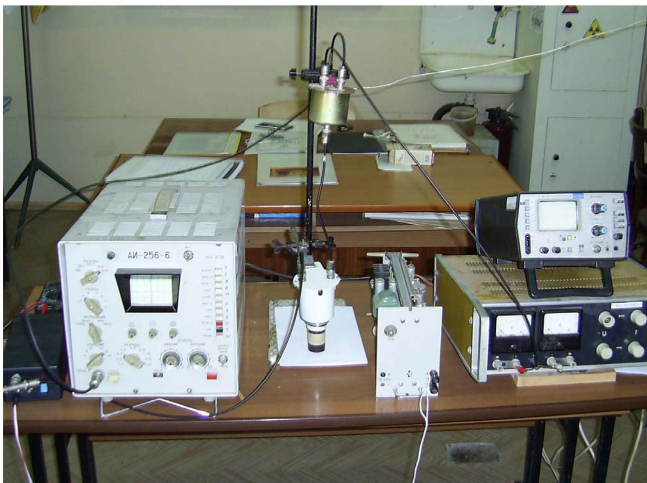
Рис. 11. Установка альфа спектрометра
