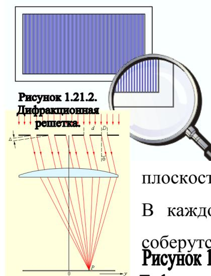
Простейшая дифракционная решетка состоит из прозрачных участков (щелей), разделенных непрозрачными промежутками. На решетку с помощью коллиматора направляется параллельный пучок исследуемого света. Наблюдение ведется в фокальной плоскости линзы, установленной за решеткой (рис. 1.21.3).
