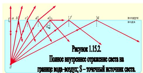
Для границы раздела стекло–воздух ( $n = 1,5$ ) критический угол равен  $\alpha_{\text{пр}} = 42^\circ$ , для границы вода–воздух ( $n = 1,33$ ) –  $\alpha_{\text{пр}} = 48,7^\circ$ .
