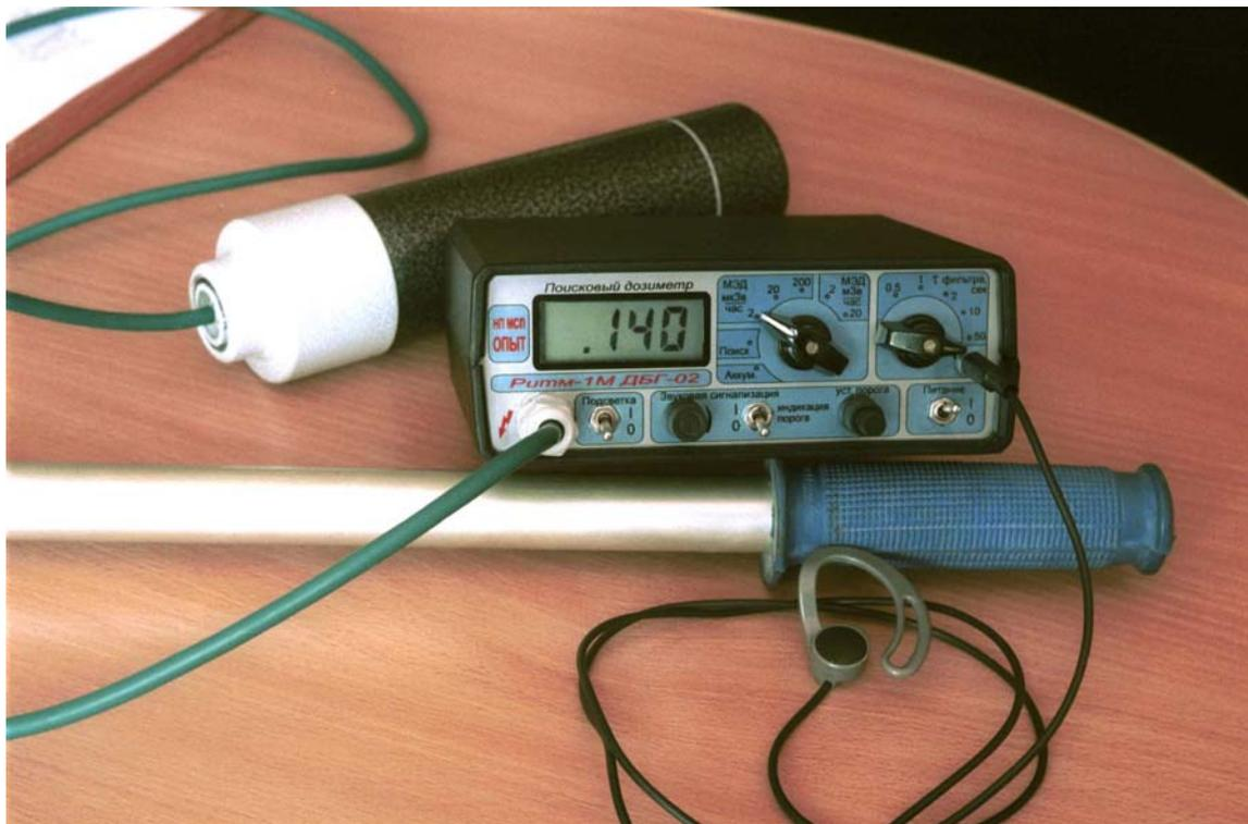
Рис. 4. Дозиметр гамма-излучения поисковый ДБГ-02 «РИТМ-1М».
